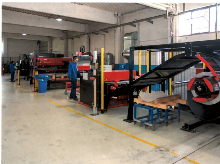
Die Blechfertigung bei Cool Compact erfolgt vom Coil und wird in zwei Arbeitsschichten betrieben.
